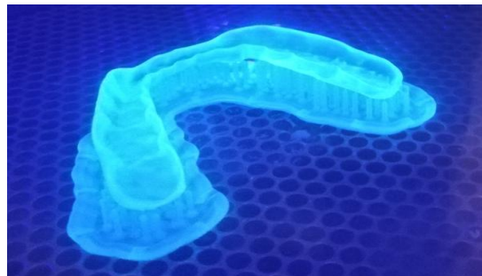
8 pav. 3D spausdinta kapa kietinama UV spinduliais
